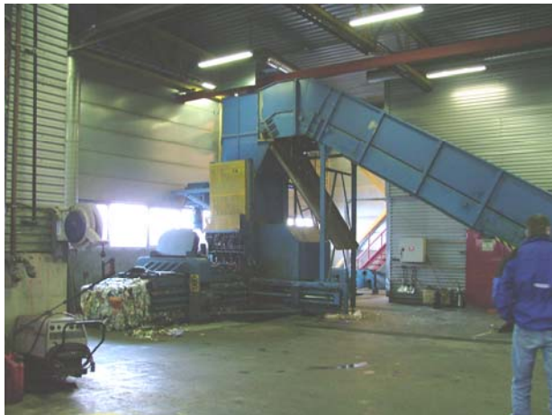
Pressing og balling av avfall på avfallsanlegget. Mars 2004.
